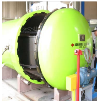
○防爆性能試験設備
